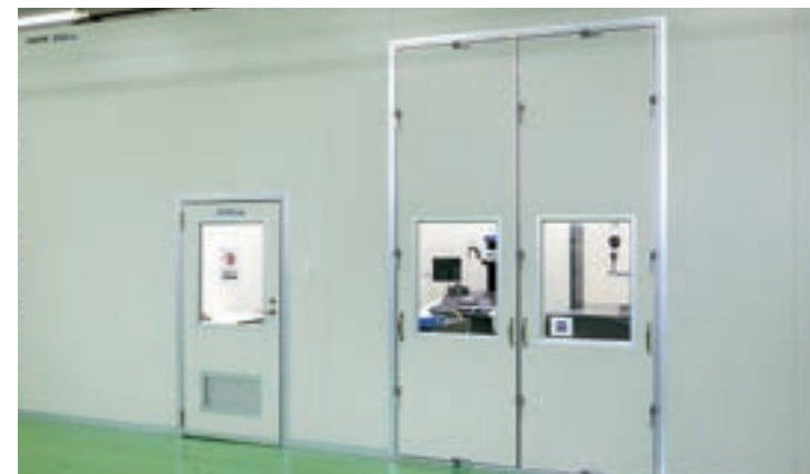
温度変化や振動等が測定に影響しないよう、測定機専用の恒温室を設置。
