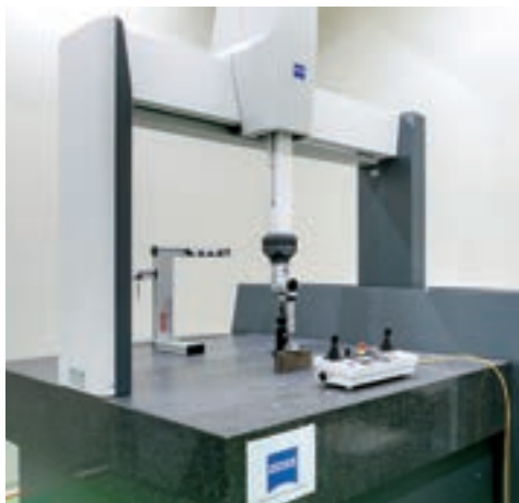
今回の事業で導入した高精度3次元座標測定機。
