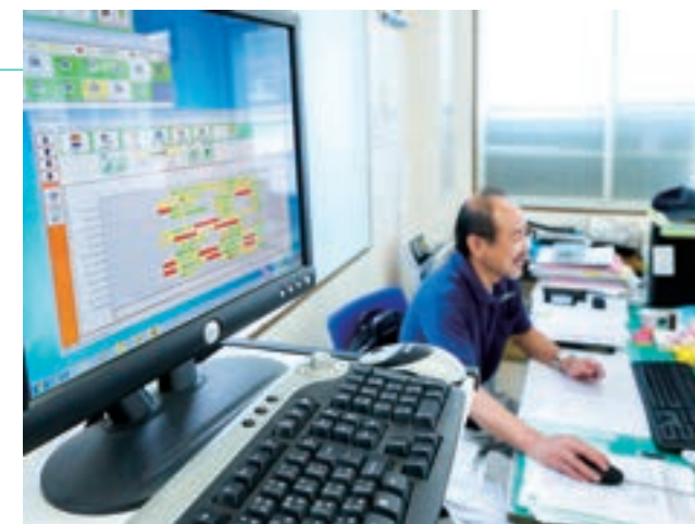
製造・検査工程での各種管理データを自動で収集・集計し、情報を一元化。必要な情報の閲覧、抽出も自由に行える。
