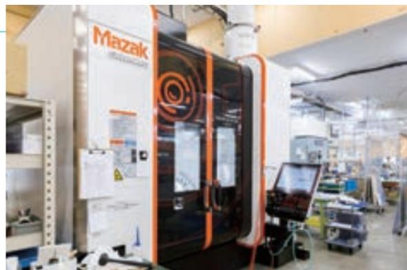
本事業で導入した同時5軸加工・高精度多面加工マシニングセンタ。
