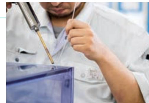
手作業となる樹脂溶接。生産プロセスの改革・改善により、生産能力の平準化が実現。
