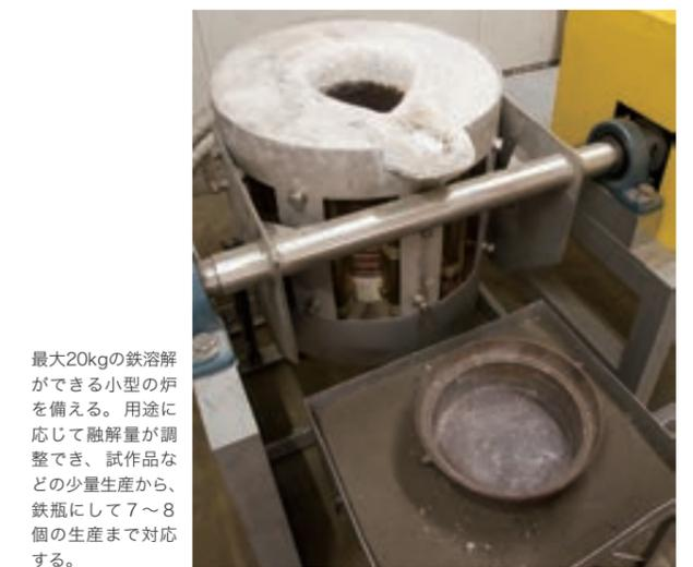
最大20kgの鉄溶解ができる小型の炉を備える。用途に応じて融解量が調整でき、試作品などの少量生産から、鉄瓶にして7~8個の生産まで対応する。
