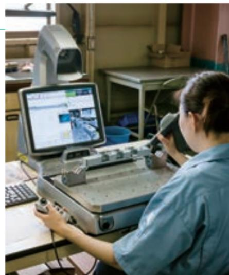
業者による測定誤差もあったが今回導入した測定機は、1回の測定で、XYZの座標が取得できるので、測定時間が大幅に短縮可能となる。
