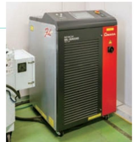
本事業で導入したハンディファイバーレーザー溶接機。
