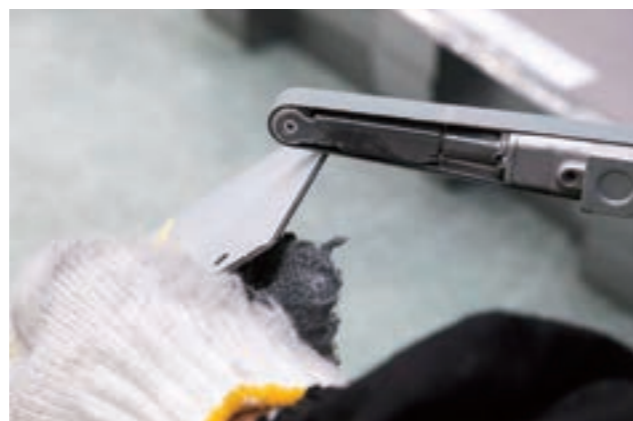
これまではスクレーパー等の工具を使い、手作業で行うことの多かったバリ取り作業。作業者の熟練度によって仕上がりにバラツキがあった。
