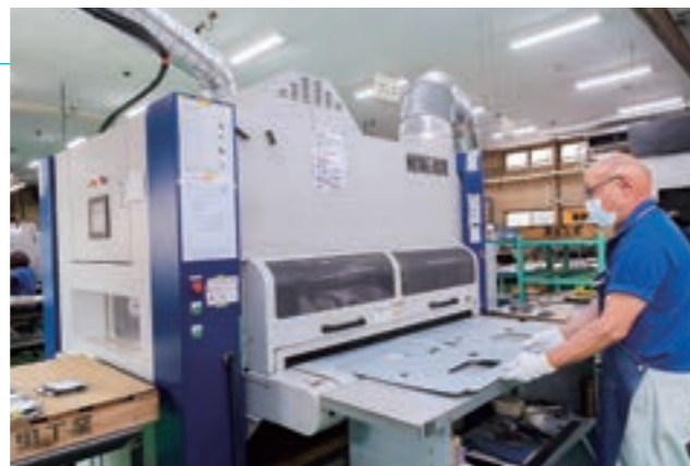
本事業により導入した高性能なバリ取り機。1,200mm幅のコンベアを備え、大型部品のバリ取りも効率的にこなす。
