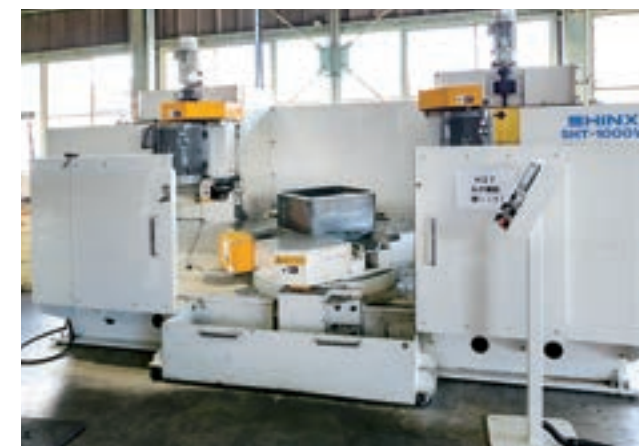
新たに導入した開先加工機。70mm から対応でき、短材コラム部の加工を容易にした。
