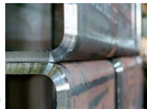
接合強度を上げるために必要な、コラム材の端に行う削り込み加工（開先加工）。
