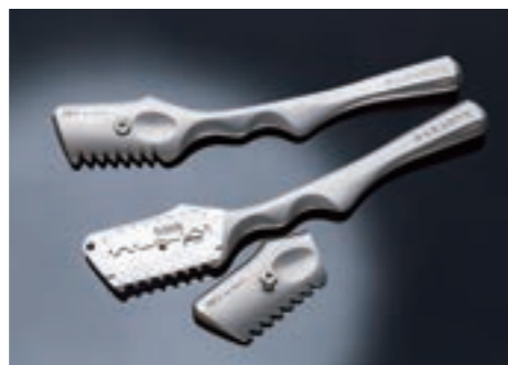
チタン合金製の レザーカット用ハンド ル「レザルテ」。両 刃の替刃を本体に 取め、蓋をして六角 ボルトを締めて固 定するという構造。
