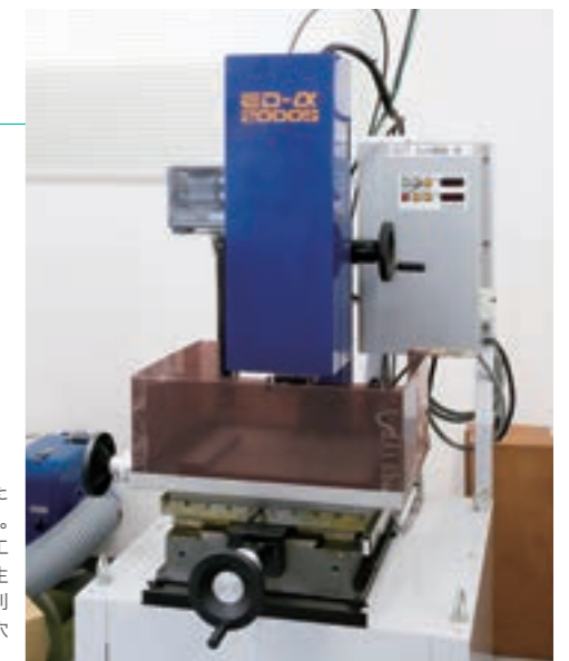
本事業で導入した細穴放電加工機。加工用電極と加工材料との間に発生する放電作用を利用して、小径の穴を加工する。
