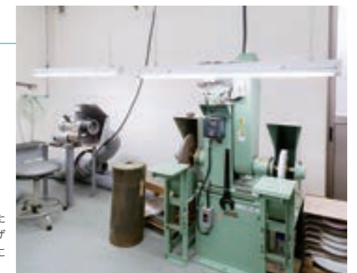
本事業で導入したバフ研磨機。レザルテの最終研磨に使用する。
