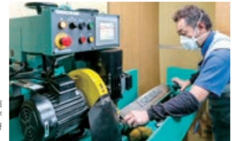
1台で粗削りと超硬部研磨の両方が可能な「全自動研磨機GX-70S」。
