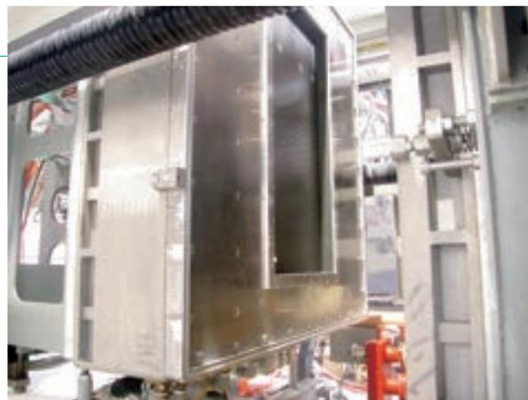
新開発した可変型の金型「多層成形金型凹型」。ソリッド層とポラス層の厚さを変えることができる。
