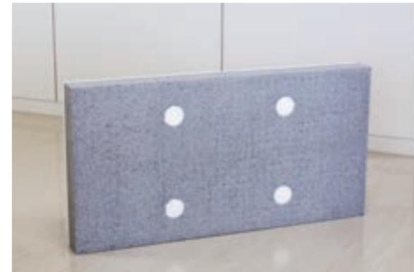
「多層成型ボード」ソリッド層にできた4箇所が通気用のポラス層との一体成型を可能にしている。
