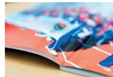
PUR製本の見開き部分。PURは接着強度が高く塗布量を少なくできるので、開きやすい本が作れる。
