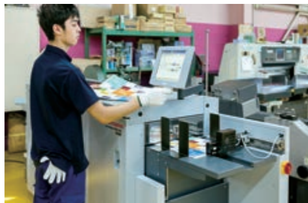
カット機能付き筋入れ機。印刷の際に筋入れやミシン入れ、断裁箇所を目印を付けておき、その用紙の目印をセンサーが感知することで加工処理を行う仕組み。
