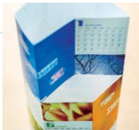
カット機能付き筋入れ機で加工処理を施した製品見本。筋入れやミシン入れが1工程で行える。
