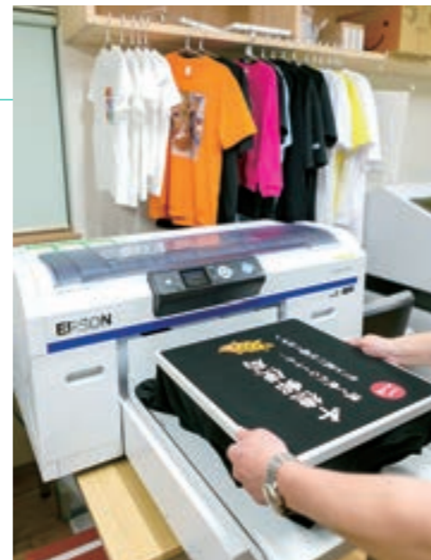
Tシャツやトートバッグなどの布に直接プリントできるプリンター。インクジェット方式でフルカラー出力が可能。
