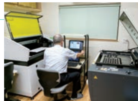
立体物への印刷ができるUVプリンター(左)とレーザー加工機(右)。この2種類の複合利用により、オリジナル商品の開発も可能となった。
