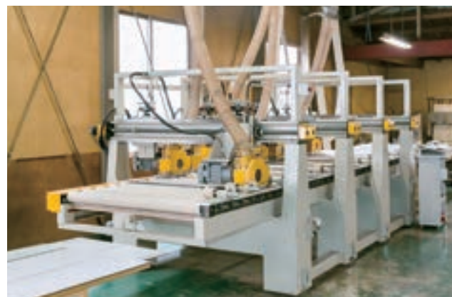
新たに導入したVカット加工機。厚さ3mmほどの化粧合板に折り曲げ溝を切削加工する設備。
