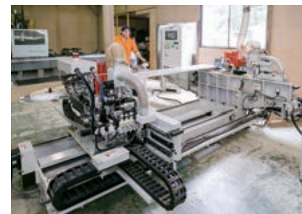
両面縁貼機。これまでは2工程3名体制で行っていた作業が、1工程1名で行えるようになった。
