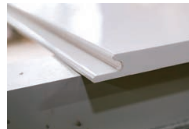
両面縁貼機により、小口シートの貼り付けを上下端同時に行い、小口シートの余剰部分の切り取りも自動化された。
