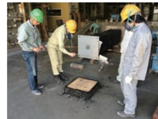
日本建築総合試験所の1時間耐火基準テストをクリア。表面の化粧層は黒く焼け焦げているが、燃え止まり層(ブロック)で燃焼は止まり、材の中心部まで及ばない。
