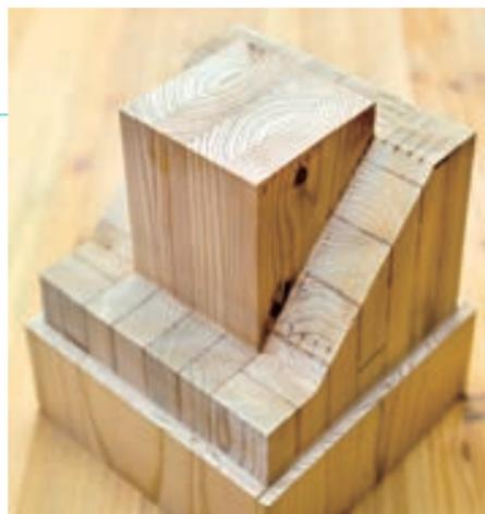
当組合が研究開発を進めてきた燃え止まり型の耐火集成材。耐火薬剤を注入した集成材ブロックでコアとなる集成材を囲み、化粧層で仕上げる。
