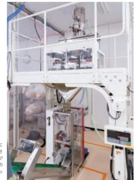
縦型自動包装機により人の手を介さず自動充填包装ができ、異物混入のリスクがなくなった。
