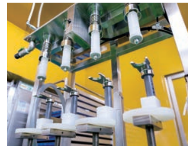
半自動充填機。2人がかりの充填作業が1人の作業になった。
