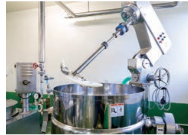
調味~加熱~冷却時に使われる練機付き回転釜。
