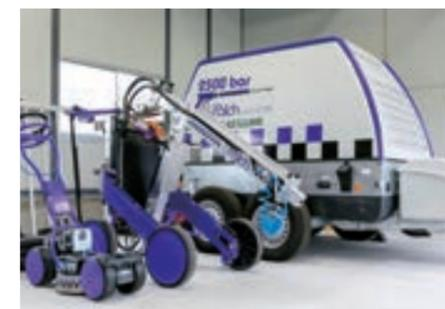
水圧でコンクリート劣化部を取り除く「トレーラージェット」。
