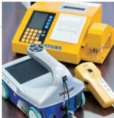
に含まれる塩分量を測り塩害を診断し、③「コンクリートテスター(打音検査機)」は、非破壊によりコンクリートの圧縮強度を測定し、健全性を判断するものである。④「トレーラージェット」は、水圧でコンクリート劣化部を取り除くもので、⑤「ダイヤモンドコアツール」は、既設コンクリートから供試体(規格に基づく試料)を採取
