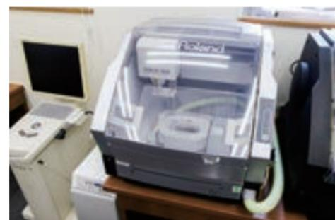
設計後に出力したデータを元に、ローランドDG社の5軸加工機を用いて切削加工を行う。
