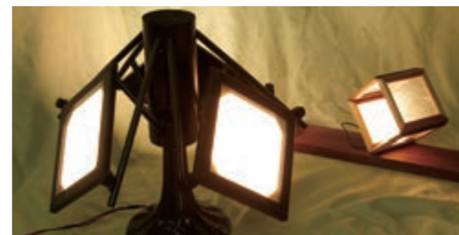
有機 EL の応用展開により、かつてないほどにフレキシブルな照明パネルが実現されつつある。紫外線や赤外線を含まないため、目や肌に優しいのも特徴。
