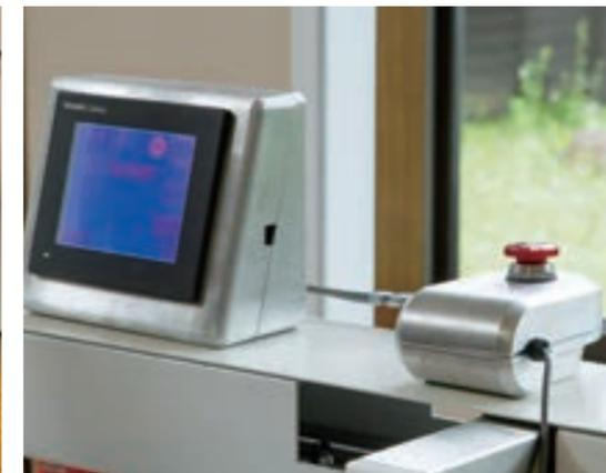
タッチパネルカバーと非常停止ボタンカバーは、本事業で導入した複合切削加工機により、社内での製作が可能となった。
