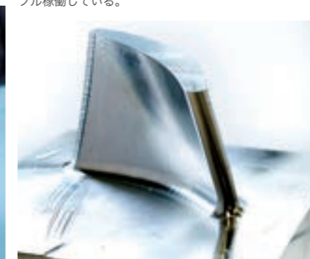
5軸加工機で加工した試作サンプル品。あらゆる形状の部品加工が可能となる。
