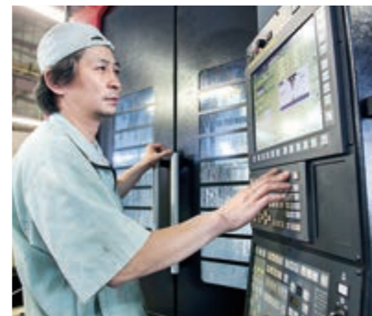
5軸加工機の導入により、工程集約によるリードタイム短縮、ワーク脱着回数減少による加工時間も削減。
