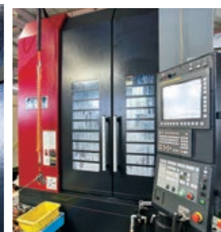
今回の事業で導入した5軸加工機。受注が増加し、フル稼働している。
