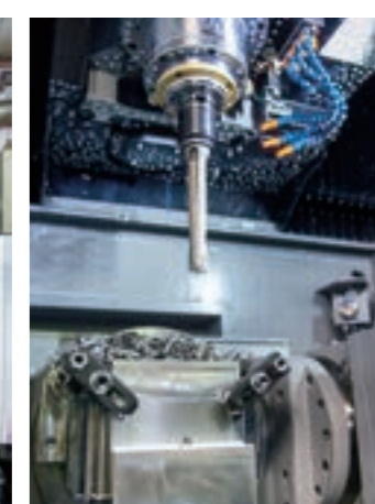
5軸加工機の内部。複雑形状の加工に威力を発揮する。
