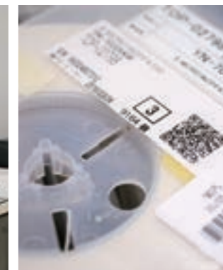
基板に組み込む電気部品にもQRコードが割り付けられる。基板のQRコードと紐を付けることで、製品単位の管理が可能となる。
