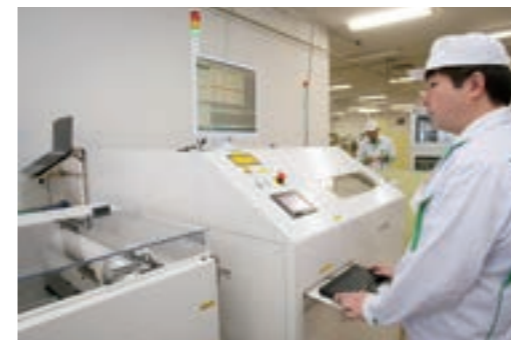
製品基板にQRコードのレーザー印字を行う。その後、読み取り用ソフトウェアを使用し、データベースに蓄積する。
