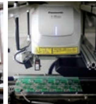
基板に直接レーザーでQRコードを印字する。
