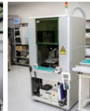
新たに導入したレーザーハンダ付けロボット。製造する部品により、適宜ラインに組み込む。
