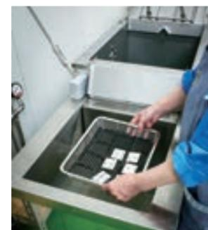
水溶性切削油の洗浄除去のため、前処理洗浄を行ってから超音波洗浄機に投入。
