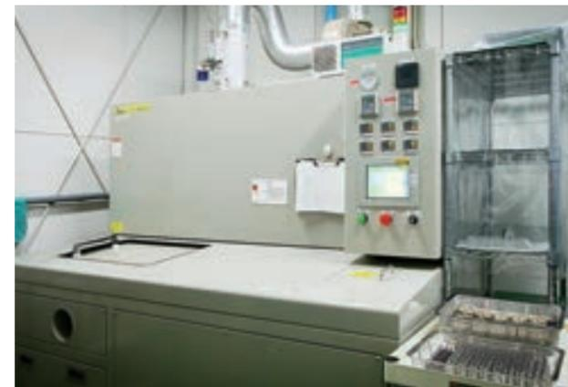
今回導入した一槽式真空超音波洗浄装置。
