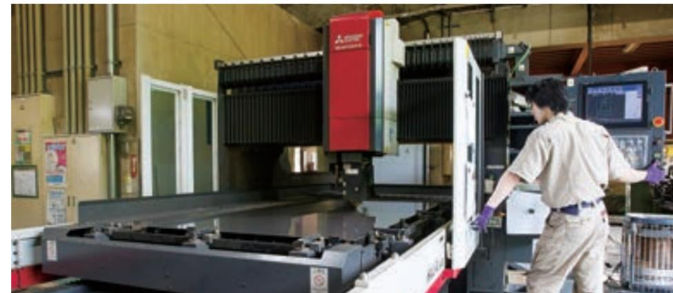
本事業で導入した炭酸ガスレーザー加工機。電解セル内部の主要部品と筐体板金の完全内製化が実現した。
