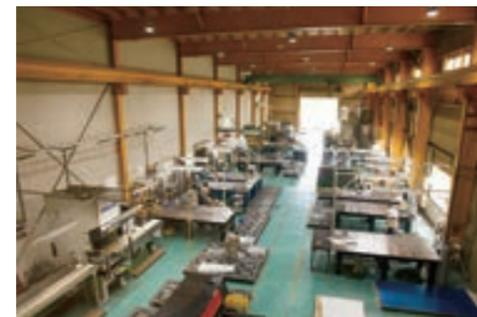
岩手工場では部品の切断や曲げ加工を担当。開発と組み立ては本社で行っている。
