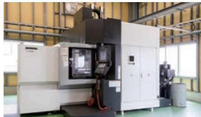
一体化構造製造に欠かせない5軸制御縦型マシニングセンタ。導入したことにより革新性の高い部品開発が可能に。
