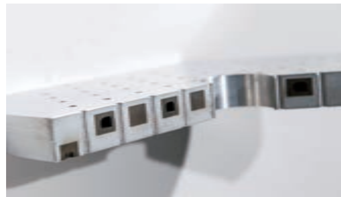
アルミ金合（基材）に内在する流路だけをステンレス合金にすることで、耐食性の向上を図る異種金属接合（SUS316L、A6061）。
