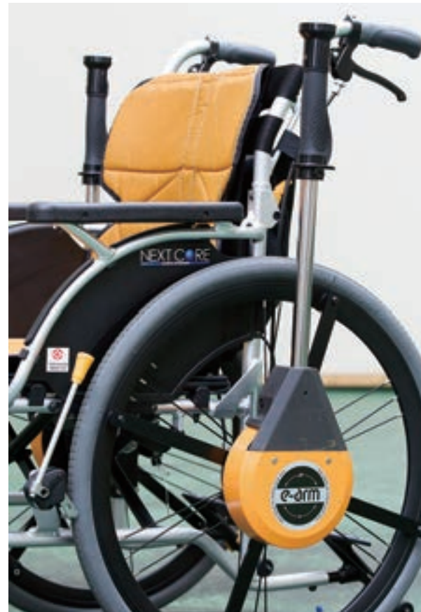
市販の車いすの両側の車輪に、レバー駆動装置を取り付けるだけ。家庭の廊下など狭い場所での移動に支障がないよう、カバーの幅も考慮。
