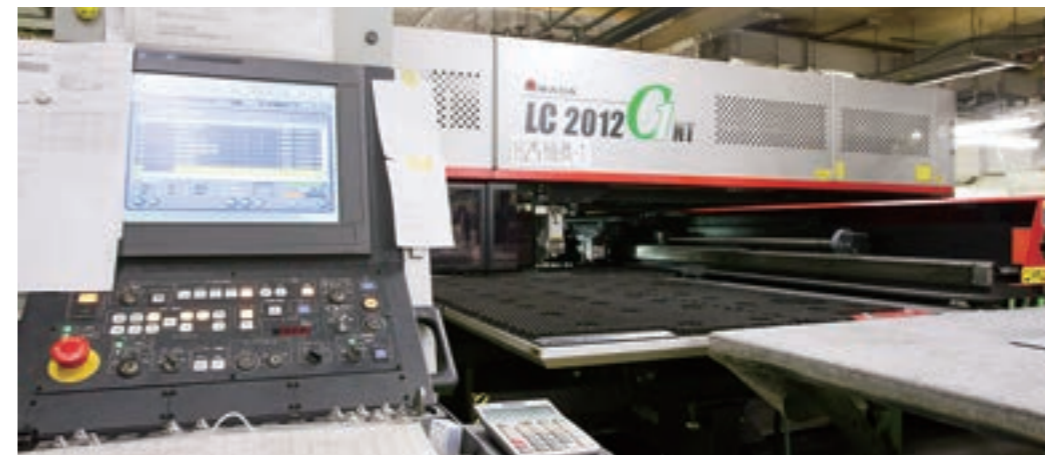
工程統合・加工領域の拡大、高精度・高品位加工を可能とする新たに導入した「工程統合マシン」。
