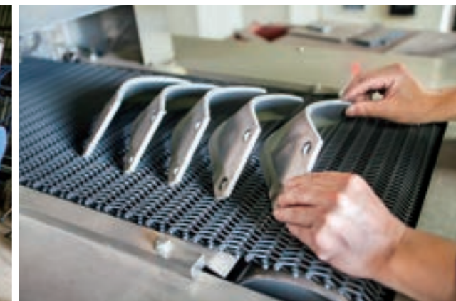
溶射を行う前の農業機械の消耗部品である耕うん爪。
