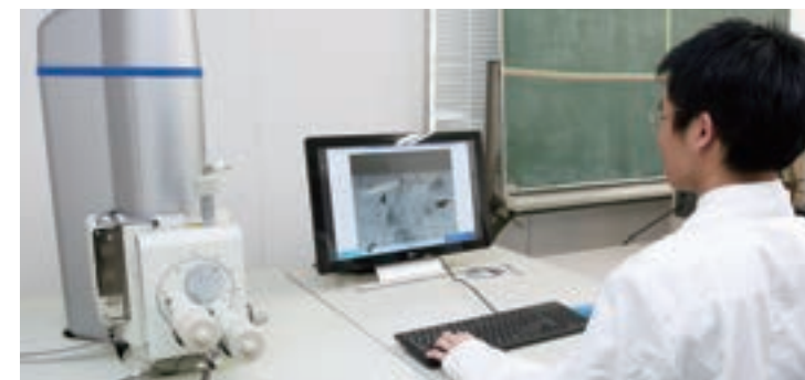
様々な条件のもとで作られた硬質クロムめっき皮膜のマイクロクラックの発生を常時把握。
