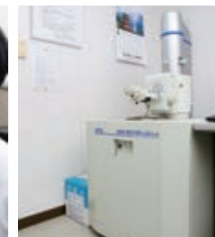
30万倍の高倍率を有する走査型電子顕微鏡。観察と同時に成分分析が可能であるため、大幅な開発工数の削減にもつながった。
