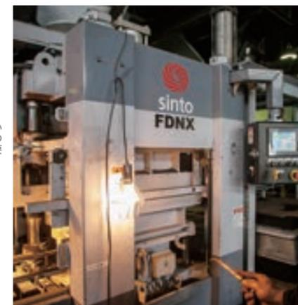
本事業で新たに導入した水平型鋳型造型機。1時間で50型を製造できる。
