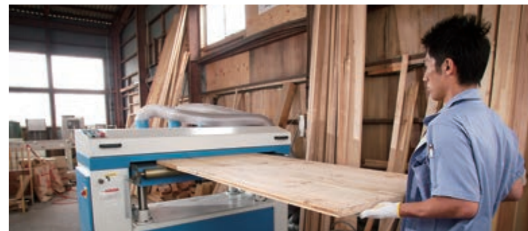
新たに導入した自動一面鉋盤。表面・裏面を各1回通すだけで、両面を平滑に整え、製品サイズに仕上げることができる。
