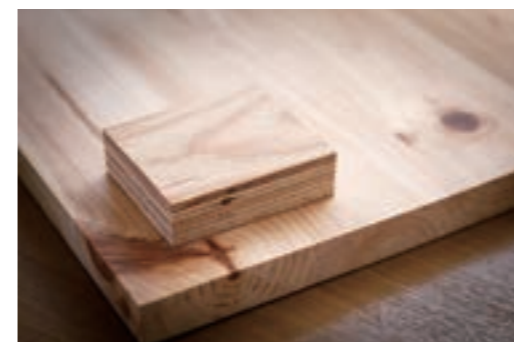
構造用合板は、薄い板状の材を縦方向に接着していくのに対し、幅ハギ集成材は、厚みのある材を横に貼り合わせて製造する。アカマツの木目の美しさが活かした仕上がりとなる。
