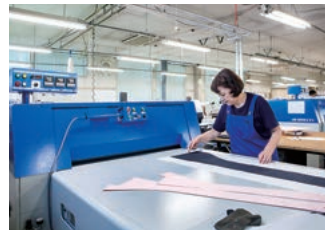
本補助事業で導入した新型の低温接着機。接着したパーツはクイックスタッカーにより自動で積み重ねられ、作業者の足元に戻る。
