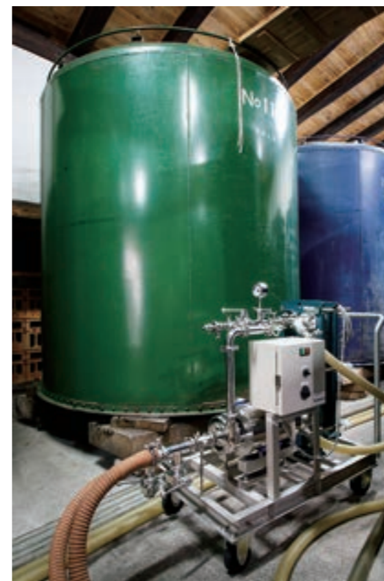
本補助事業で導入した簡易型火入酒急冷装置。加熱後の清酒を装置内に引き込み熱交換により温度を下げ、タンク内と循環させることで急冷する。
