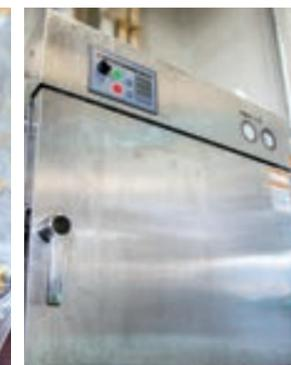
真空冷却機により減圧することで、食品の細胞に酵素を一気に染み込ませる。
