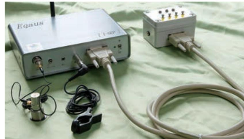
異常検出装置の試作1号機。プザーとLEDランプの点滅、無線LANで異常を通知する。
