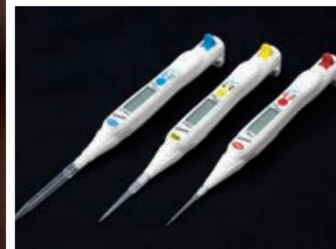
ペン型電動ピペット「ピベッティ」は20µL、250µL、1000µLの全3機種。
