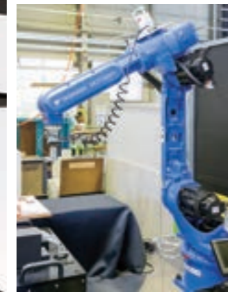
人間の腕のように自在に角度を動かせる、6軸多関節ロボットでガラスを切断。
