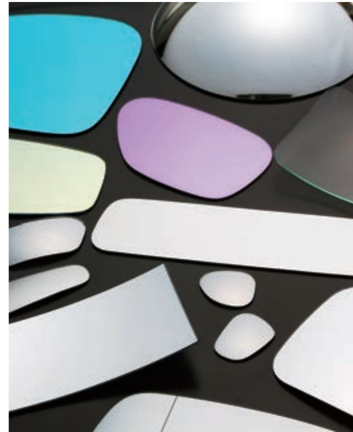
ガラスに熱を加えて自重で型に落とし込む、独自技法で仕上げたミラー。
