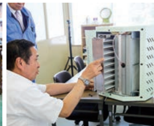
製品化第一号の据え置き型光触媒空気循環装置「サンアールエコクリーン」。光触媒プレート部分をユニット型にすることでメンテナンスの簡易化・合理化が可能に。
