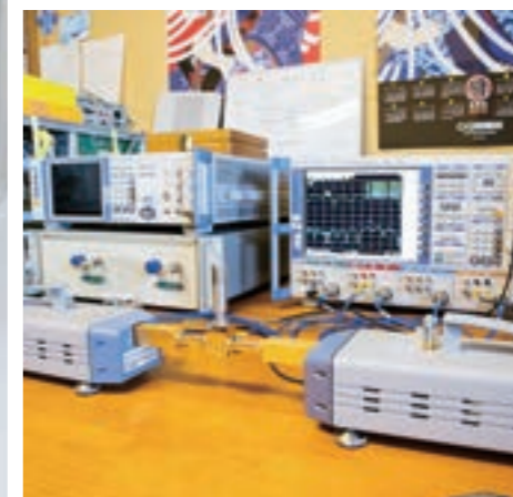
本予算で導入した「ミリ波ベクトルネットワークアナライザ」により、社内測定が可能に。
