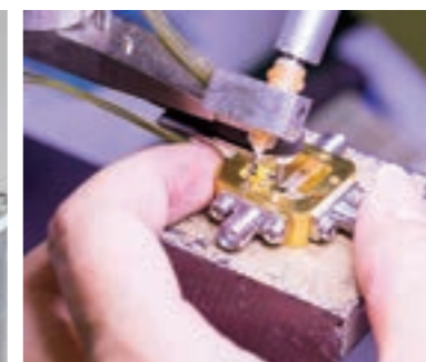
内部に入るIC（集積回路）を、金のワイヤーで配線する（ワイヤーボンディング）。
