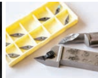
超精密切削加工を可能とするコバルト合金専用のバイト（刃）。
