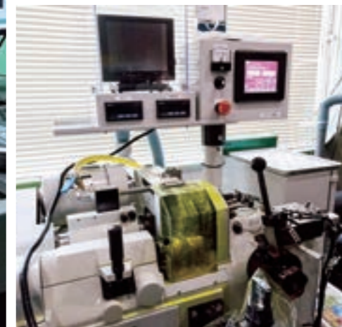
レンズ芯測定器の導入によりレーザー用小径レンズの測定誤差を解消することに成功。
