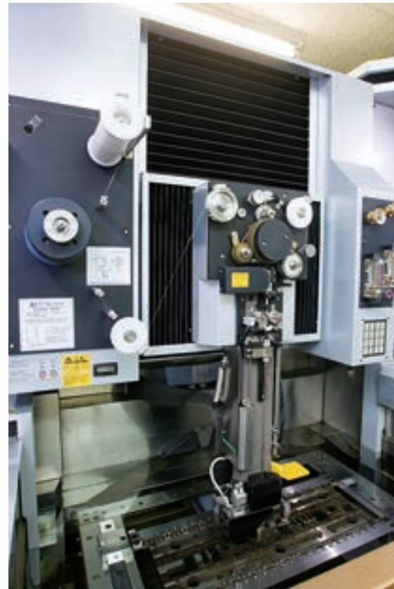
ワイヤに流した電流をスパークさせ、金属を溶かしながら切断していくワイヤ放電加工機。
