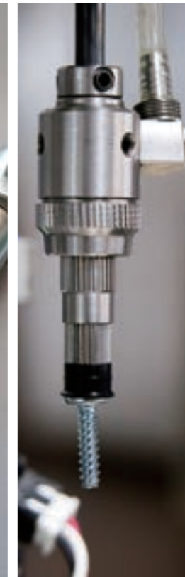
真空圧によってロボットの先端にネジを保持。正確なネジ締め付けが可能に。
