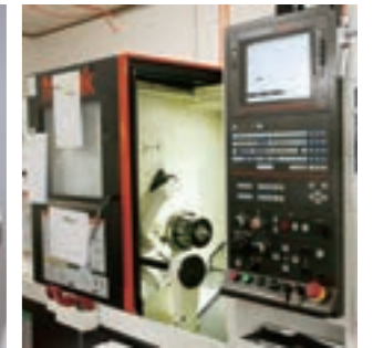
NC 自動旋盤では、高速回転で重切削が可能に。表面粗さ精度を確保することができる。
