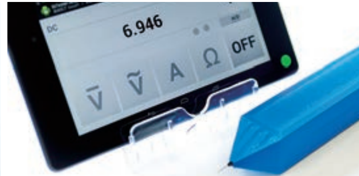
ペン型オシロスコープのデータは、スマートフォンやタブレットに表示。印刷も可能に。
