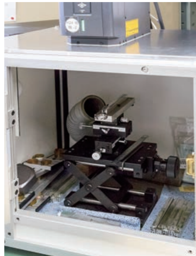
レーザー加工機と設置台。加工時に発生するガスの拡散を防ぐため箱状になっている。
