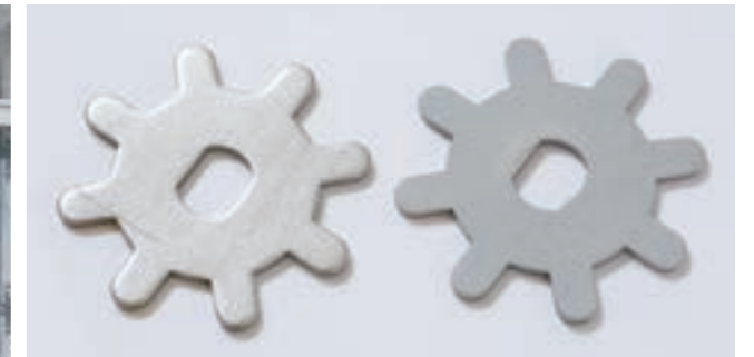
右が、ステンレス基材にコールドスプレー装置で高温耐食皮膜を施した部品。
