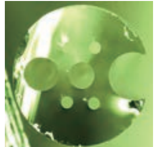
直径2mm段階の、新構造のハイブリッド電極の断面図。この後タングステンを挿入し0.3mmまで引き延ばす。
