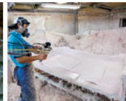
スプレーアップ工法では、ガラス繊維の飛び散りや有害ガスの揮発なども避けられなかった。
