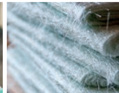
強化ガラス繊維。Light RTM 成形では、型に繊維シートを置き、そこに樹脂を流し込む。
