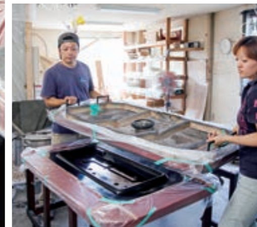
キャビティ型（下型）とコア型（上型）を重ね、その間を真空減圧し樹脂を流し込んでいく。
