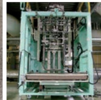
発泡スチロールをバキュームで吸引し、傷つかなないように搬送する取り出し装置。
