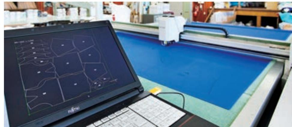
1枚裁断設備機器導入により、既存裁断機を稼働したまま試作品の製作が可能に。
