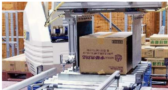
アキュムコンベアで仕分けをする様子
