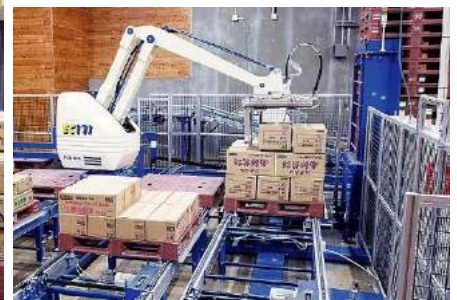
パレタイズ設備で商品を積み上げる様子
